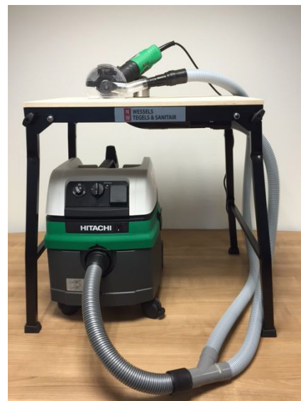
Hitachi tegelslijper G13SR3 met Kaidl afzuigkap, werktafel met afzuiging en een Hitachi RNT 1225 M stofzuiger (of gelijkwaardig)
